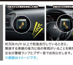
約30km/h以上で前進走行しているときに、隣接する車線の後方に他の車両がいることを検知して、左右の警報ランプとブザー音でお知らせします。
