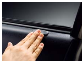
⑨帯電防止プレート
