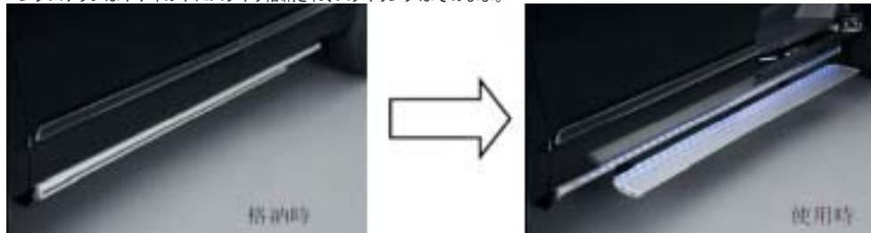
●ステップ全面を照らす39球のLEDイルミネーションにより、暗い場所での安全性を確保するだけでなく、夜間のドレスアップ性も向上。
