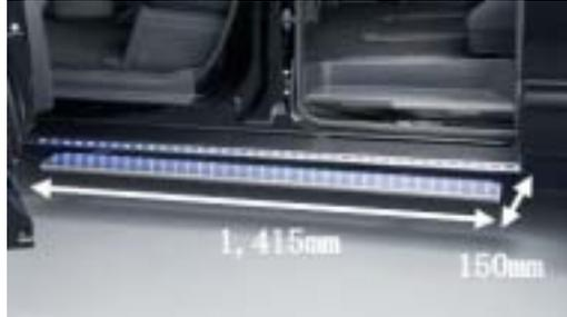
●助手席/スライドドアの開閉に連動し、ロングステップが自動で作動。ロングステップはボディの下にスッキリ格納され、スタイリングはそのまま。
