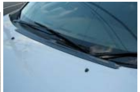
汎用フロントエアスポイラー装着例及びエンド部の画像です。
